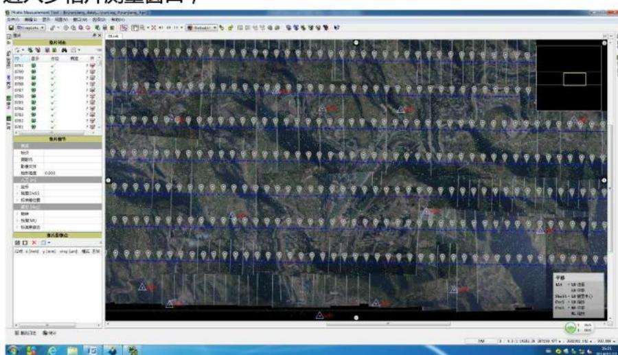
根据所显示的航片，调整航片的旋转，使得整个测区的航片排列正确。
