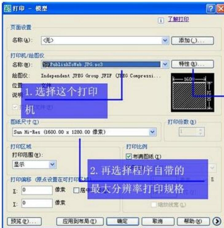
3. 如果打印精度不满足要求, 最后再点击这个按钮添加新的分辨率。添加完毕后在第2项的下拉列表里进行选择
